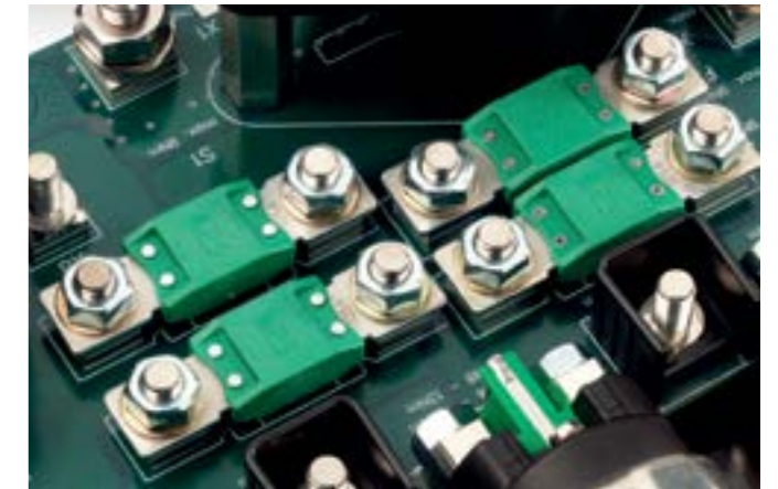
Anbindung einer Megafuse an zwei M8 PowerElement- Stifte
