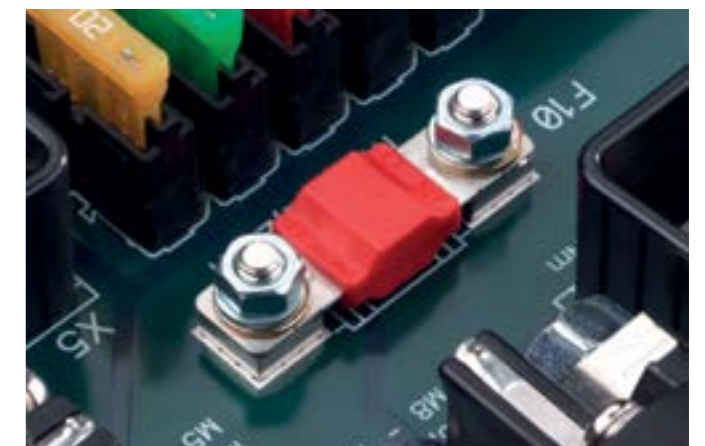
Anbindung einer Midifuse an zwei M5 PowerElement- Stifte
