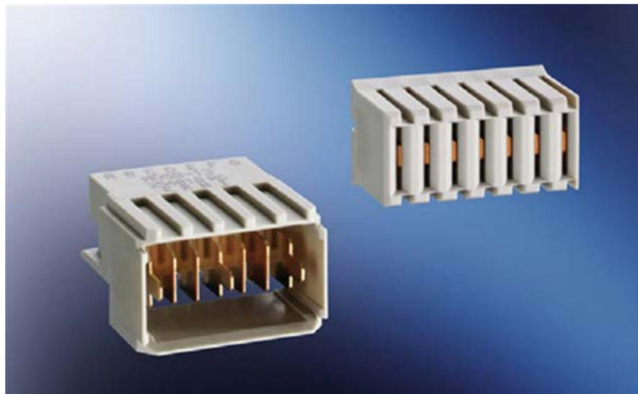
ERNI Electronics公司已经对其硬公制通用电源模块 (UPM) 进行了升级, 包括推出新型的5针、6针和7针版本。这些通用电源模块 (UPM) 系列扩展了现有的3针电源模块产品。这些通用电源模块 (UPM) 系列产品具有较高的功率等级, 每个触点可承载12.6 A的电流 (3针版本, 在20°C时温度条件下)。并且, 提供三种类型的触点端接长度, 互相之间相差1.6 mm。
